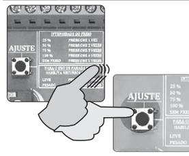
**AJUSTE - Ajuste dos níveis de FREIO**
